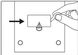
Вставьте батарейку или удалите защитную изоляционную полосу (2 x AAA 1,5 V).
