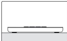
Установить весы на прочную ровную поверхность.
