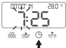
Чтобы подтвердить свой выбор, нажмите символ часы. На экране замигают цифры для установки часов.
