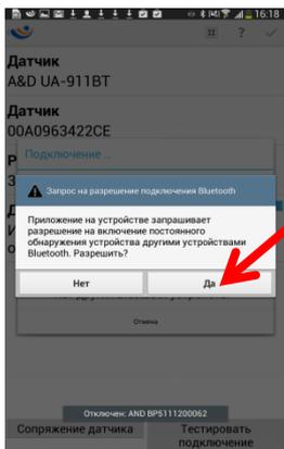
Подтверждаем запрос на включение модуля Bluetooth на приборе.
