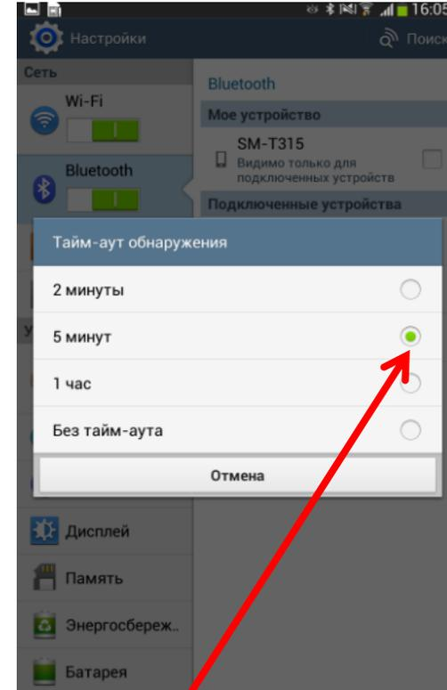
Для обеспечения надежности сопряжения тонометра со смартфоном установим Тайм-Аут обнаружения на минимум 5 минут. Для этого необходимо нажать кнопку «Меню» на Вашем смартфоне, выбрать пункт «Тайм-аут обнаружения» и поставить галочку на 5 минут
