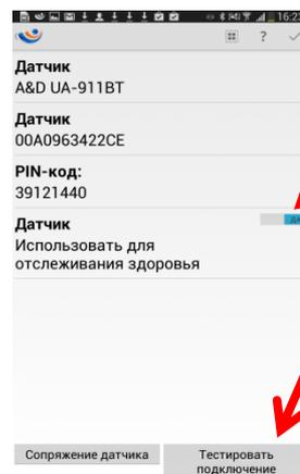
Ставим кнопку «Датчик. Использовать для отслеживания здоровья» в положении Да. После этого необходимо произвести измерение на тонометре. По окончании измерения сразу нажимаем пункт «Тестировать подключение»
