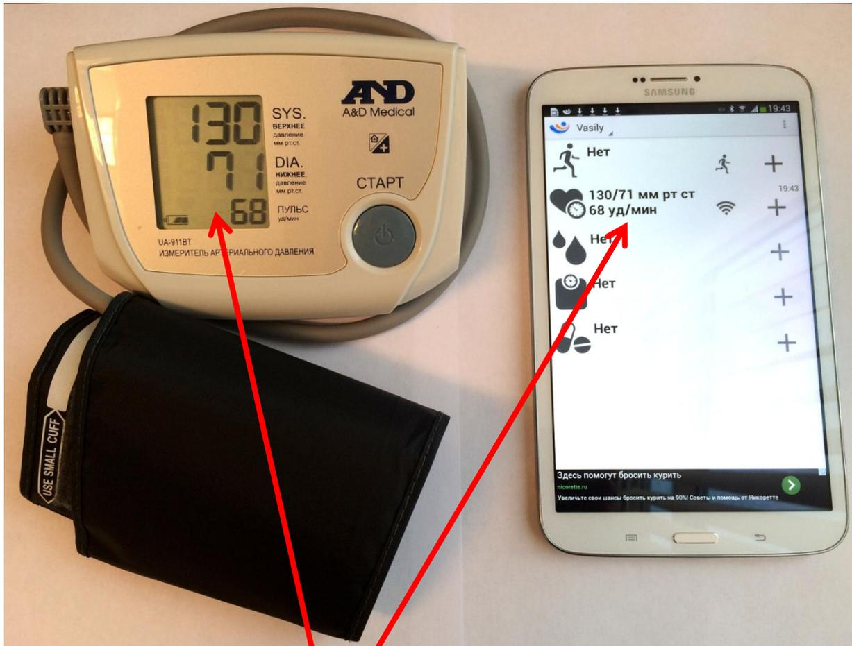
Передача данных с прибора на телефон
